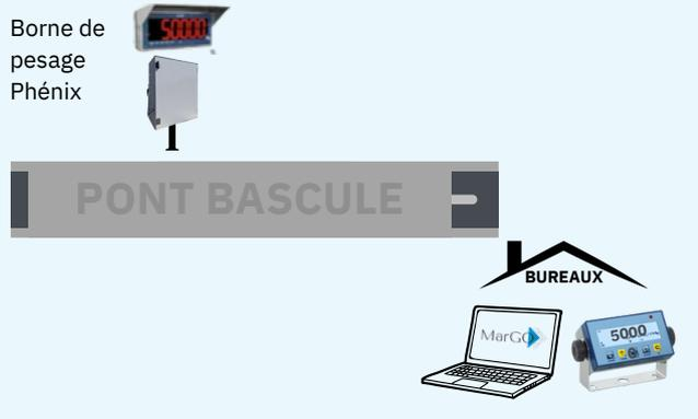
1 pont bascule avec borne phénix en entrée, borne phénix en sortie, indicateur et logiciel MarGo en bureau
