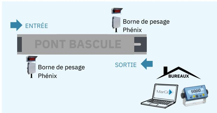
1 pont bascule avec borne télépesage, indicateur et logiciel en bureau
