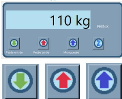
Permet de réaliser des pesées à l'entrée du camion et à sa sortie ou des monopesées.
